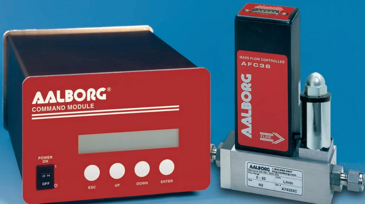
Die kombinierten Gasströme werden durch ein elektromagnetisches Dosierventil mit einer entsprechend gewählten Blendenöffnung geleitet. Durch die Regelung im geschlossenen Kreis wird der Massenausgang ständig überwacht und auf der eingestellten Durchflussrate gehalten.
