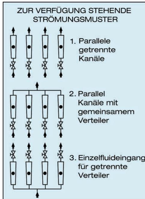
Die Einbauventile werden immer in dem dem Verteiler gegenüberliegenden Endblock installiert.
