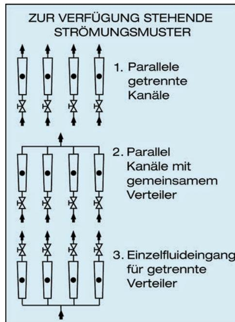
**Werden Messgeräte mit Ventilen bestellt, so werden die Ventilpatronen eingangsseitig installiert.**
