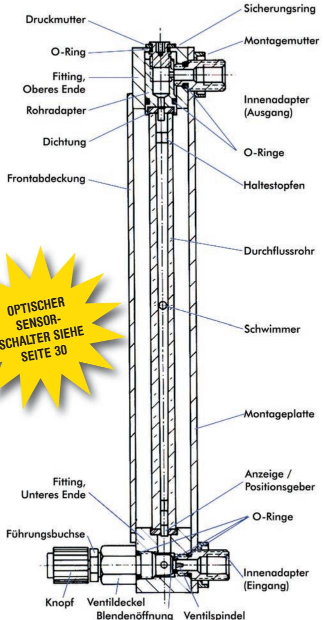
Auf einem einzigen Montagerahmen können verschiedene Durchflussrohre verwendet werden, was bei vielen Labor-anwendungen als ein offensichtlicher Vorteil anzusehen ist.
