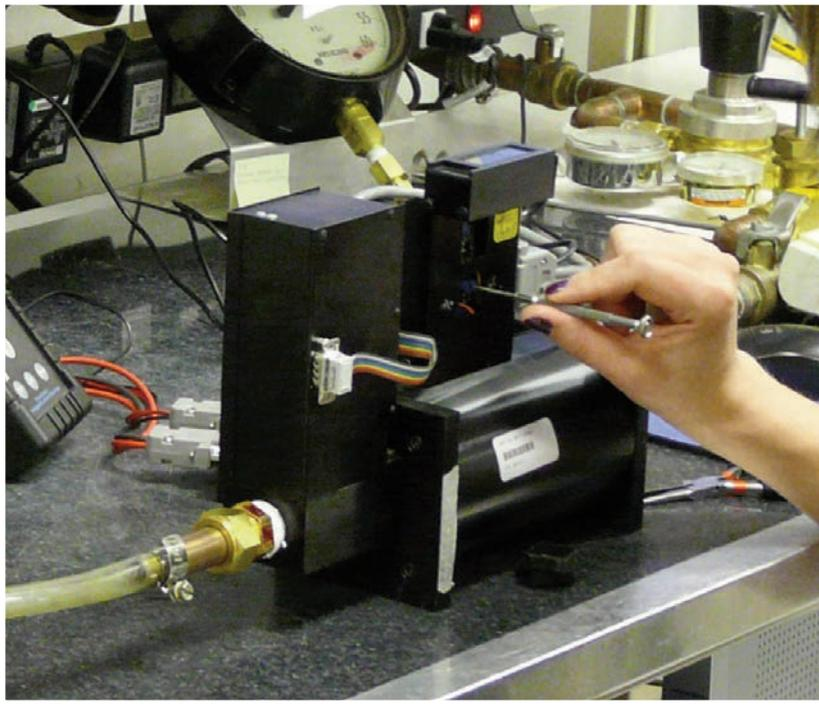
Das Gasdurchfluss-Kalibrierlabor ist in der Lage, Kalibrierungen von 1 mL/min bis 1000 L/min bei 21,1° C /101.325 kPa (70° F, 14.69 PSI abs.) durchzuführen.
