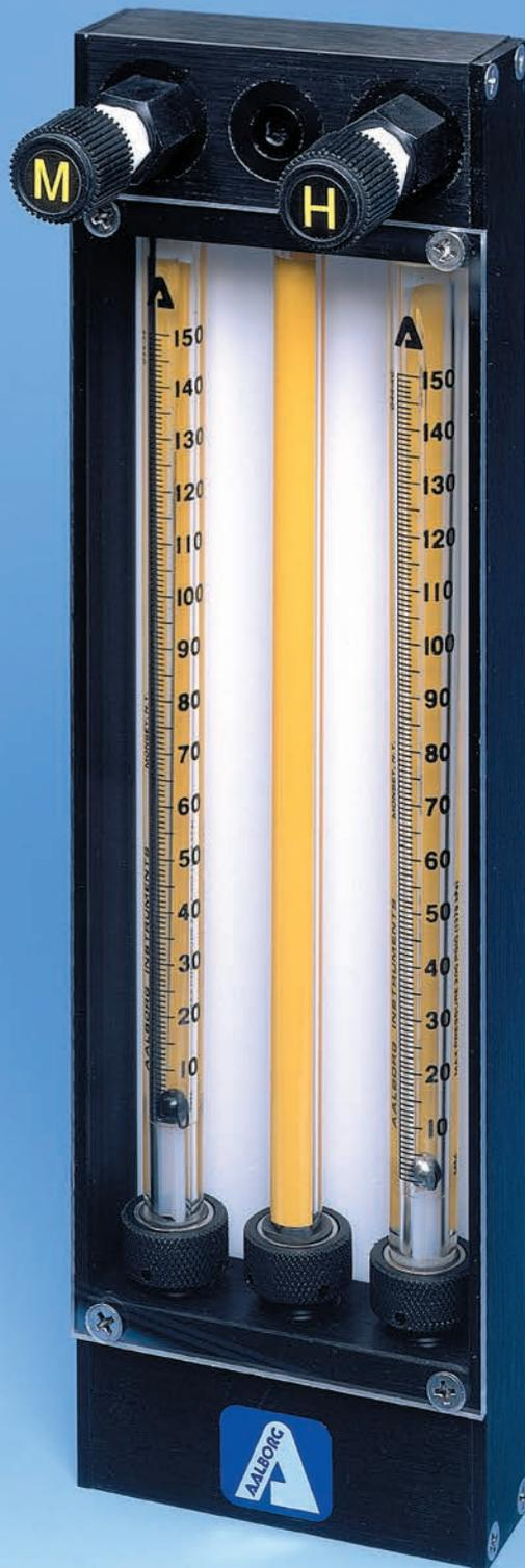
Gasmischer mit CV™ -Ventil
