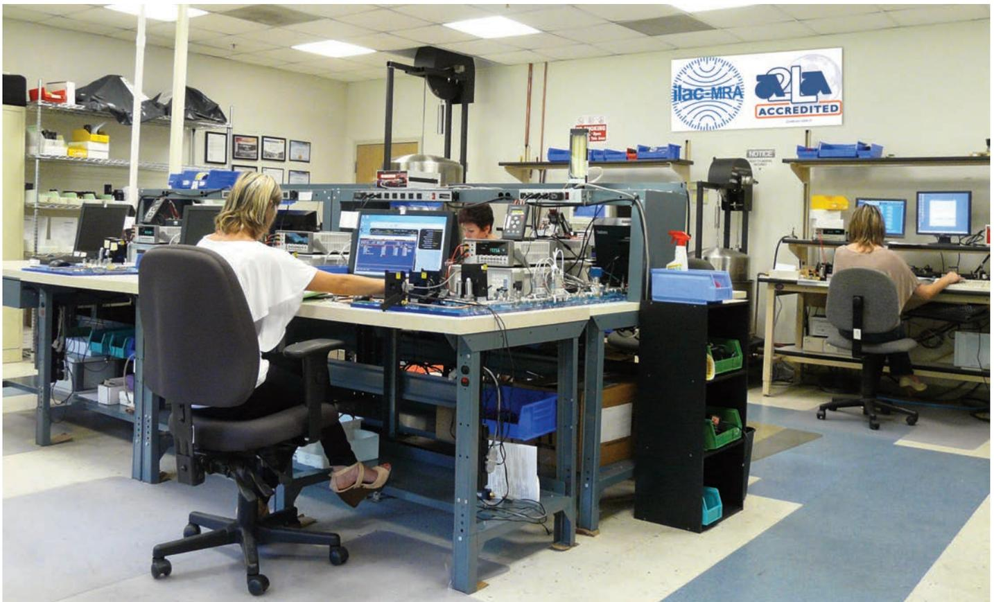
Techniker kalibrieren Massenflussregler unter Verwendung von Prüfglocken und Molbox/Molblocs-Technologie.
